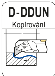
Antivibrační typ D s otvorem pro chlazení
